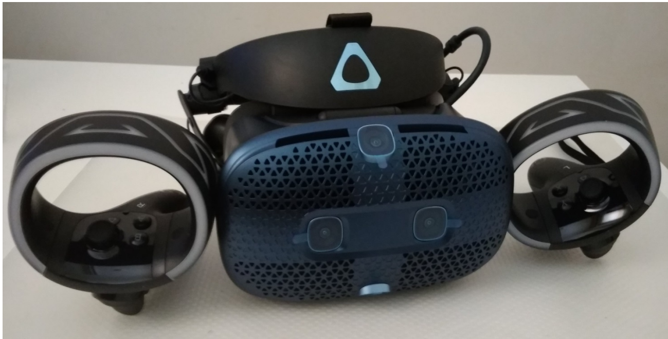
с) 3D шлем виртуальной реальности с датчиками-манипуляторами пространственного положения
